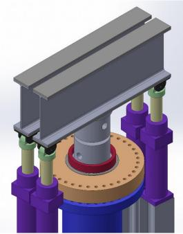
La tipologia di sezione scelta attualmente è IPE 600 rinforzata e realizzata con acciaio S355. Sarà necessario inserire su entrambi i lati della sezione una piastra di spessore pari a 21 mm con dimensioni analoghe alla sezione della trave stessa per quanto riguarda larghezza e spessore, al fine di garantire un modulo di resistenza sufficiente per trasmettere il carico.
