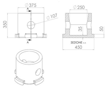
Si è introdotta una svasatura nella parte superiore al foro in modo da garantire un minimo di libertà allo stelo durante la fase di test.
