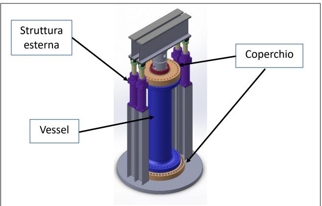
Il **Vessel** è la struttura cilindrica progettata per contenere un ambiente pressurizzato, con entrambe le estremità chiuse tramite un coperchio che viene vincolato alla flangia del vessel tramite bulloni. Il sistema di tenuta è realizzato mediante l'uso di guarnizioni e bulloni, il suo scopo è garantire il non trafilamento.
