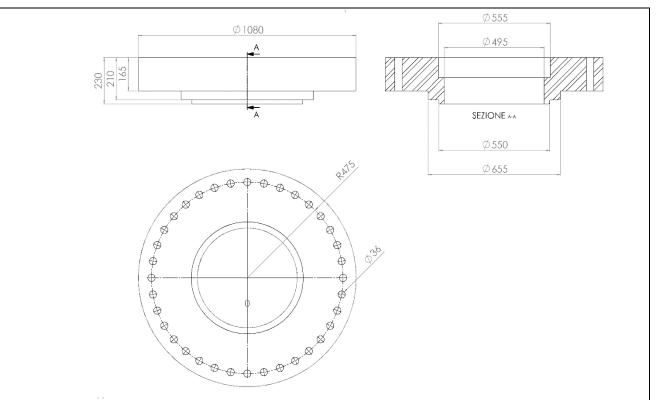
Dovrà avere un diametro esterno di 1080 mm ed uno spessore variabile. A partire dal centro si chiede di realizzare uno spessore di 230 mm ed un diametro di 550 mm, utile per la centratura del coperchio sul vessel. A seguire dovrà essere realizzato un cilindro di spessore 210 mm e diametro pari a 655 mm, utile per far lavorare correttamente la guarnizione. Per finire si prevede uno spessore di 165 mm, con diametro esterno massimo di 1080 mm.
