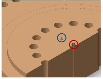
Al centro del coperchio inferiore bisognerà prevedere una spina centrale con un foro passante, al fine di mettere in comunicazione l'interno del prototipo con l'ambiente esterno.
