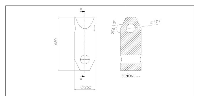
Aggancio a boccola per lo stelo: Si prevede di realizzare un cilindro cavo in cui sia realizzato un foro per il passaggio del perno. Sulla base saranno realizzati dei lobi, in un numero di 3 o 4, in modo da vincolare tramite un sistema a baionetta il sistema di trasporto del carico con il prototipo.
