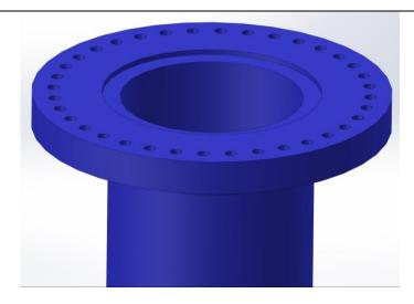
• Coperchio inferiore: questa componente ha la finalità di sigillare il vessel e mantenerlo sotto pressione, in particolare dovrà avere dei fori ciechi per inserire una corona di bulloni per vincolarlo con la flangia del vessel e una seconda corona di fori passanti per vincolarlo alla struttura esterna. Si prevede di realizzarlo sempre con acciaio X65.
