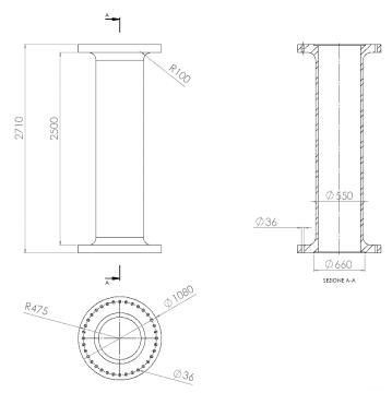
• Flangia: il vessel deve prevedere un sistema di flangia su entrambe le estremità al fine di poter applicare una corona di fori passanti per bulloni di tipo M33. La flangia dovrà avere un diametro esterno di 1080 mm e una corona di 36 fori passanti per bulloni M33 posti su una circonferenza con diametro 950 mm.
