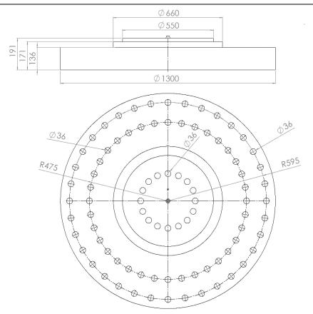
Al fine di garantire una corretta centratura del coperchio si è ipotizzato un ulteriore livello con spessore di 20 mm; si dovranno inoltre considerare altre misure che garantiscano una maggiore facilità nel corretto posizionamento del coperchio sul vessel.
