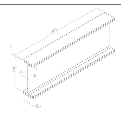
• Colonna per struttura esterna: Un sistema di colonne permetterà di scaricare a terra il carico sviluppato dagli attuatori e di porre quest'ultimi ad un'altezza sufficiente per collegarsi con il sistema di trave.
