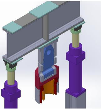
Stelo: Si prevede di realizzare uno stelo con un diametro di 250 mm in cui dovranno essere realizzati due fori perpendicolari tra loro e con un diametro di 100 mm (Per semplicità nel CAD si è disegnato con un foro M100 che ha un diametro pari a 107 mm). Con lo scopo di lasciare un po' di gioco nel sistema si prevede di realizzare una lavorazione sugli estremi dello stelo.
