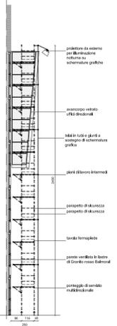
SEZIONE AA - TELAI A SOSTEGNO DI SCHERMATURA GRAFICA
