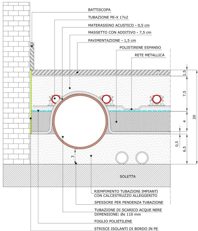
**DETTAGLIO PANNELLI RADIANTI A PAVIMENTO SOLETTA PIANO TERRENO**
