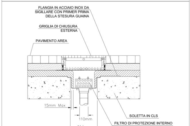
**DETTAGLIO COSTRUTTIVO PASSAGGIO CANALI E TUBAZIONI - 1:25**
