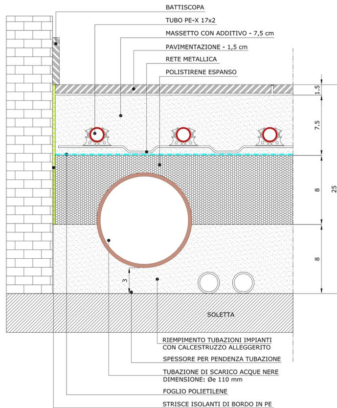
**DETTAGLIO ATTRAVERSAMENTO GIUNTO DI FRAZIONAMENTO**
