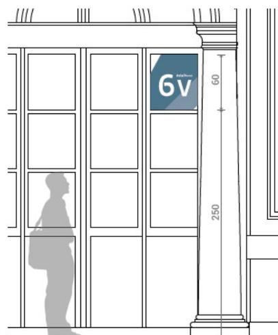
I pannelli prevedono diverse colorazioni riportate su entrambi i lati della lastra mediante l'impiego di vernici in grado di resistere agli agenti atmosferici e garantire la tenuta del colore nel tempo (per i colori, si confronti l'Allegato 4), mentre per le vetrofanie si tratterà di grafiche adesive retroapplicate al supporto in vetro. Le colorazioni dei singoli pannelli/vetrofanie afferiscono alle indicazioni RAL fornite in Allegato 4.
