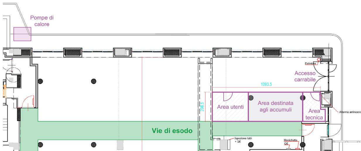
Figura 2: Schema dell'area destinata all'impianto prototipale oggetto dell'affidamento (in viola), con individuazione del posizionamento esterno delle pompe di calore, dell'area interna destinata agli accumuli, dell'area tecnica in cui dovranno essere installati skid pompe, quadri elettrici ecc, e dell'area che sarà occupata dagli utenti.
