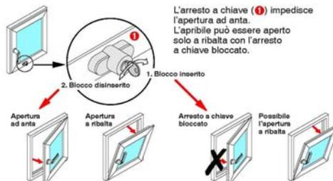
L'arresto a chiave (1) impedisce l'apertura ad anta. L'apribile può essere aperto solo a ribalta con l'arresto a chiave bloccato.
